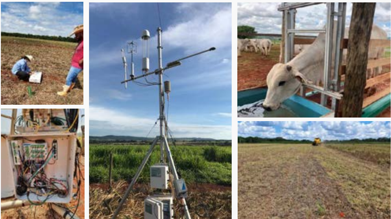
Figura 20: Quantificação do óxido nitroso utilizando câmeras estáticas. A área experimental possui um sensor de Eddy covariance, que mede continuamente 24 horas na emissão de CO 2 e de metano. Esses dados são associados às informações meteorológicas
